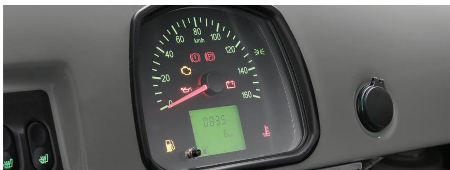
Tablero de instrumentos y tomacorriente de 12 V
