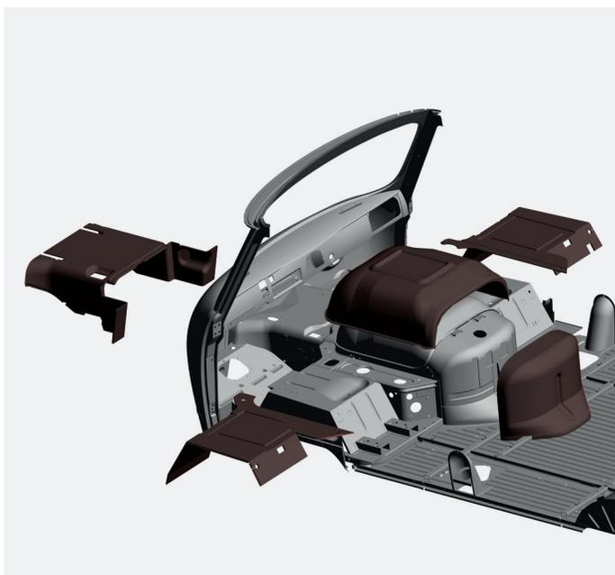
Gracias al aislamiento mejorado acústico del motor y al aislamiento contra las vibraciones de la carrocería se ha logrado un ambiente cómodo en el vehículo. El aislamiento acústico con superficie de lanilla mejora la acústica y el acabado interior de la cabina.
