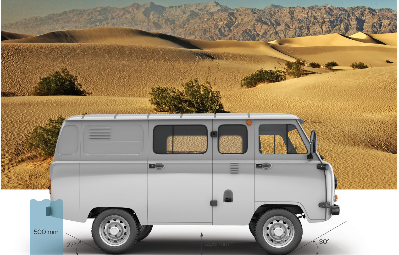
\* Altura mínima del chasis – distancia del suelo al cárter del eje.
