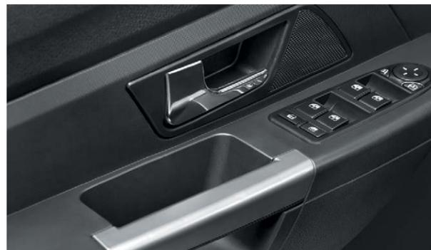
Control de los elevalunas eléctricos y los espejos exteriores en la puerta del conductor
