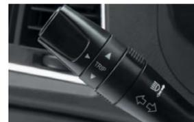
Mando de nuevo diseño con modo de seguimiento de las luces intermitentes y control de la computadora de a bordo
