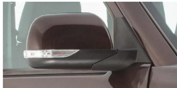
Espejos retrovisores del color de la carrocería con luces de giro integradas
